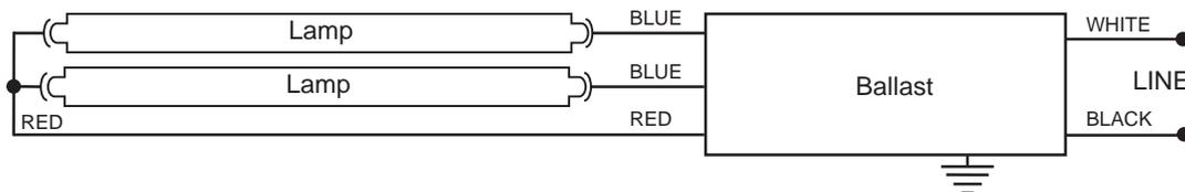
4 Pin Wiring Diagram
