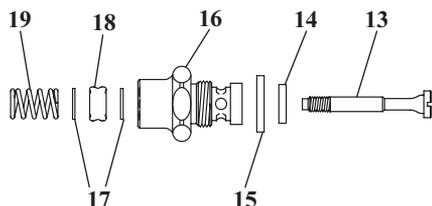
5. Ensamble de nuevo la parte No.16 insertando la parte No.13 a través de todas las partes. Sostenga la parte No.20 con el alicate y cuidadosamente atornille la parte No.13 dentro de la parte No.20 hasta que se sienta ajustada. No use fuerza excesiva.
