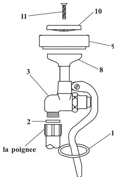
8. Pour remplacer N°2, dévisser la poignée de N°3 et remplacer avec un nouveau N°2.
