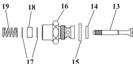
5. Pour remonter le N°16 insérer N°13 à travers tous les parties. Tenir N°20 avec les pinces et visser prudemment N°13 dans N°20 jusqu'à la vis est fixe. N'utiliser pas la force excessive.(voir l'étape N°4).
