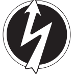
Attention - courant électrique
