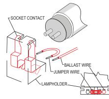
BLACK RED LINE WHITE BALLAST YEL BALLAST MUST BE GROUNDED 1 LAMP BLACK RED LINE WHITE BALLAST YEL BALLAST MUST **BE GROUNDED** \_ 2 LAMP
